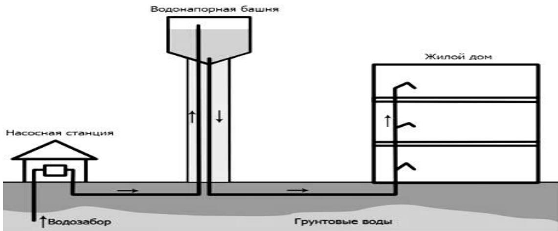
Рисунок 1.1 Упрощенная схема водоснабжения СП Петровка
