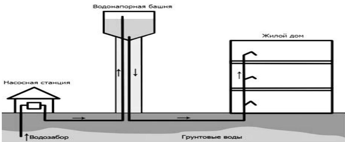
Рисунок 1.1 Упрощенная схема водоснабжения СП Гвардейцы
